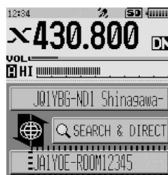
Rys. 3.1.2. Okno na ekranie FT2DE po odebraniu z przemiennika adresu węzłów WIRES-X
