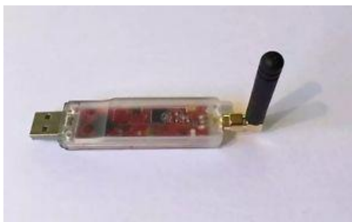
Fot. 2.2.1. Mikroprzeźniennik „DV4mini” umożliwia pracę w systemach D-Star, DMR, C4FM, APCO P25, dPMR i NEXTEEDGE (NXDN). W chwili obecnej dostępne jest oprogramowanie sterujące dla Windows i „Maliny”
