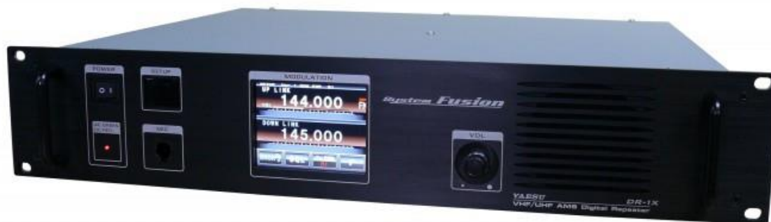
Fot. 2.4.1. Przebiennik DR-1XE zawiera wewnątrz dwie radiostacje FTM-400DE
