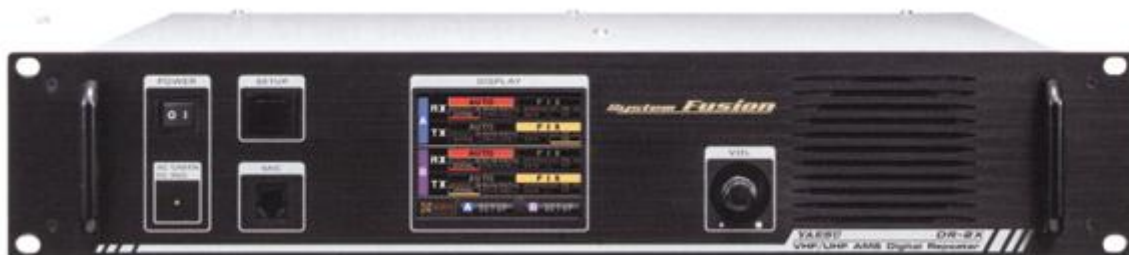
Fot. 2.4.3. Przeмиennik DR-2X. Do pracy w sieci YAESU konieczny jest dodatkowy moduł LAN-01A. Moc wyjściowa jest przełączania między 50 W, 20 W i 10 W. Przeмиennik jest wyposażony w funkcję automatycznego przełączania na awaryjne zasilanie z akumulatora
