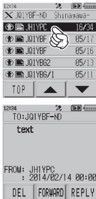
Rys. 3.2.4. Wybór wiadomości ze spisu i jej otwarcie na ekranie. Przyciski u dołu pozwalają na skasowanie („DEL”), udzielenie odpowiedzi („REPLY”) lub przekazanie jej dalej („FORWARD”). Do przewijania dłuższych spisów służą klawisze strzałek
