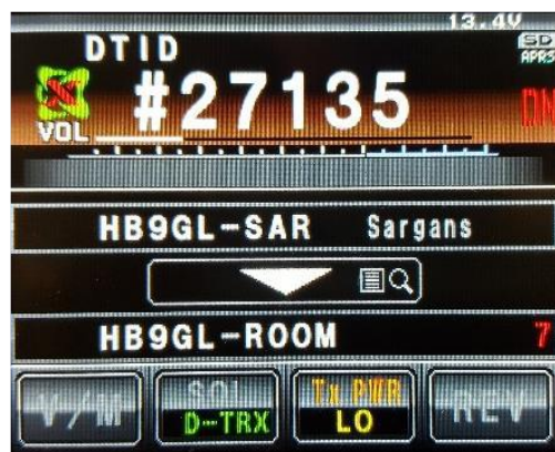
Rys. 3.4.2. Wpisywanie adresu węzła z mikrofonu FTM-400DE
