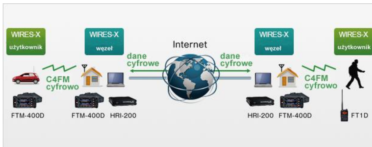
Rys. 3.1. Połączenia przemienników przez WIRES-X
