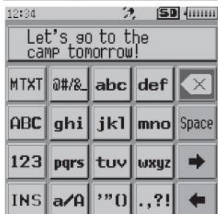
Rys. 3.2.11. Pisanie wiadomości tekstowej przy użyciu klawiatury dotykowej. Po skończeniu wiadomości należy nacisnąć klawisz „BACK”
