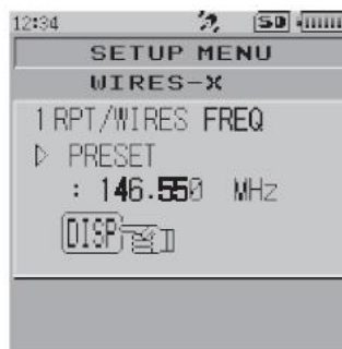
Rys. 3.3.2. Wybór funkcji „1 RPT/WIRES FREQ” i wpisanie częstotliwości
