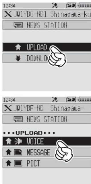
Rys. 3.2.13. Nadawanie wiadomości głosowych. Po wybraniu w menu wiadomości głosowej należy nacisnąć przycisk nadawania i mówić do mikrofonu, a na zakończenie zaprzestać nadawania
