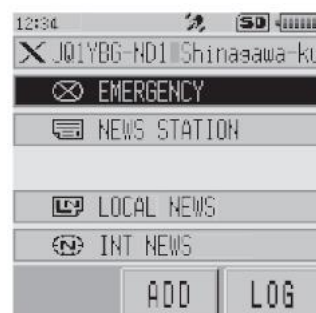
Rys. 3.1.6. Menu węzła odległego po połączeniu się z nim
